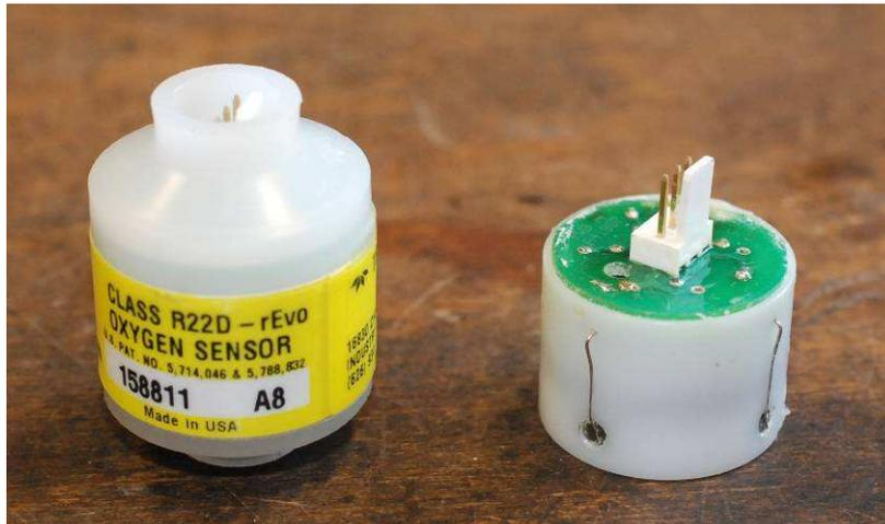
Links sieht man einen kompletten Sauerstoffsensor rechts sein Innenleben, nachdem die Plastikhülle entfernt wurde. Bei dem inneren Bauteil sieht man oben einen Stecker (männlicher Molex Stecker, andere Sensoren benützen manchmal auch andere Stecker), der auf einer Platine sitzt. Darunter befindet sich die galvanische Zelle von der zwei Kabel zur Platine laufen.
